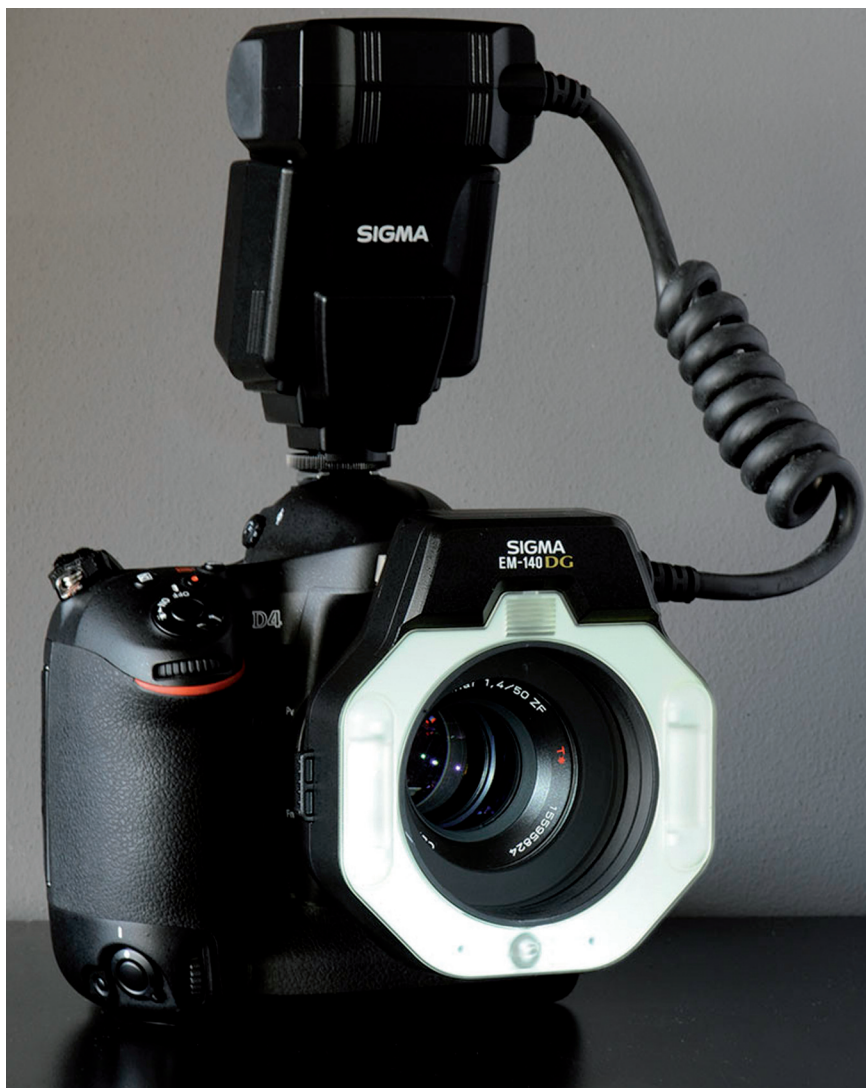
Foto 2-12. Spiegelreflexcamera met een ringflitser. Dit flitslicht komt recht van voren, maar geeft toch een veel mooiere egale verlichting. Ideaal voor close-up opnamen, maar ook een redelijke overzichtsfoto kan goed met de ringflitser verlicht worden.
