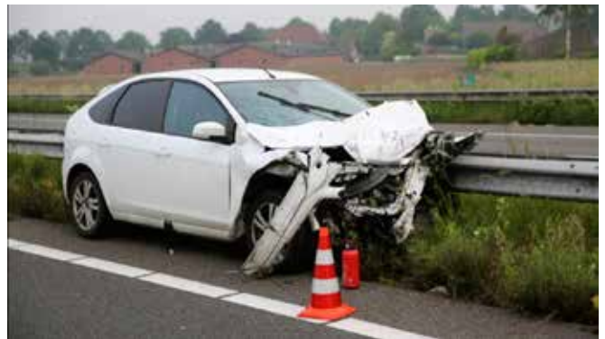
Foto 2. De kreukelzones hebben de vrijgekomen kinetische energie geabsorbeerd
