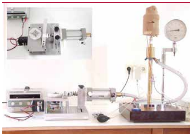
Figuur 2. Meetopstelling om dynamische stiffness index te meten. Inzet: luchtdrukgenerator die is verbonden met een vormwiel voor het nabootsen van de loopcyclus en druksignalen naar de Ton stuurt met daaroverheen een kous.
